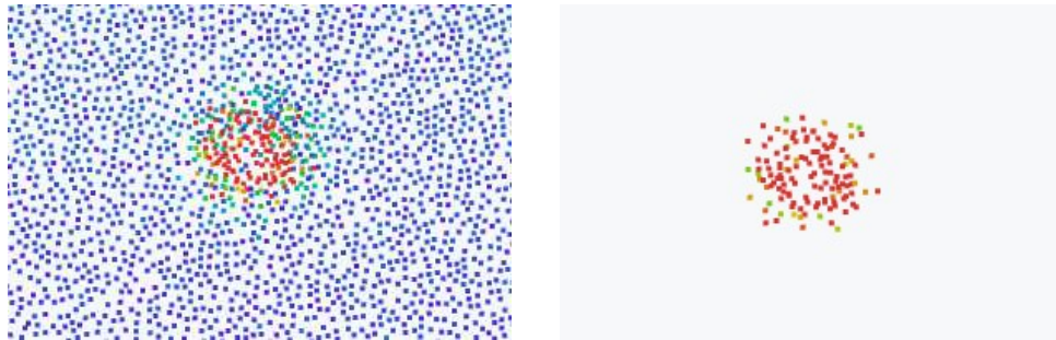
Figuur 2: Punten geëxtraheerd van een cirkelvormig, hoogreflecterend target in de puntenwolk
