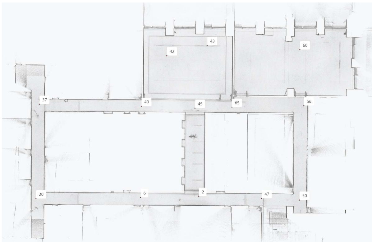
Figuur 1: Bovenaanzicht van de puntenwolk van de testlocatie en verdeling van de targets (de 13 targets die in de evaluatie zijn meegenomen)
